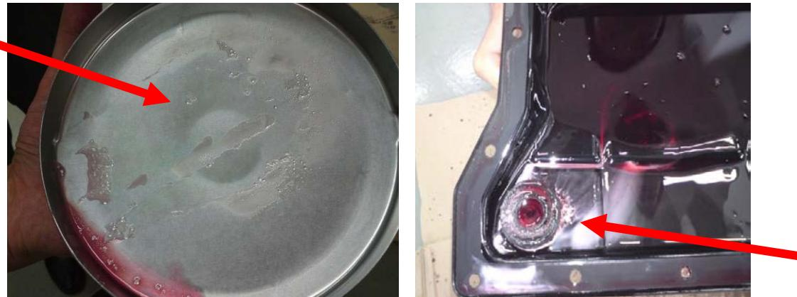
如果主动锥轮端盖内部有白色物，油底壳也有同样的白色物，则充分证明变速箱中有水或者变速箱中混入了其他的油或者液体。尽可能的将变速箱中的油放出来并且将滤清扔掉。更换新的滤清并且依据 2.1 章节重新加注变速箱油。
